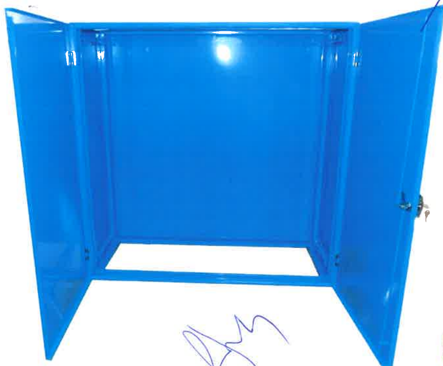
Стъпка5 Монтиране на врати
